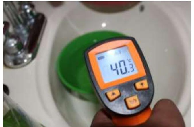
Fig. 7 Temperatura de agua de calentador solar
